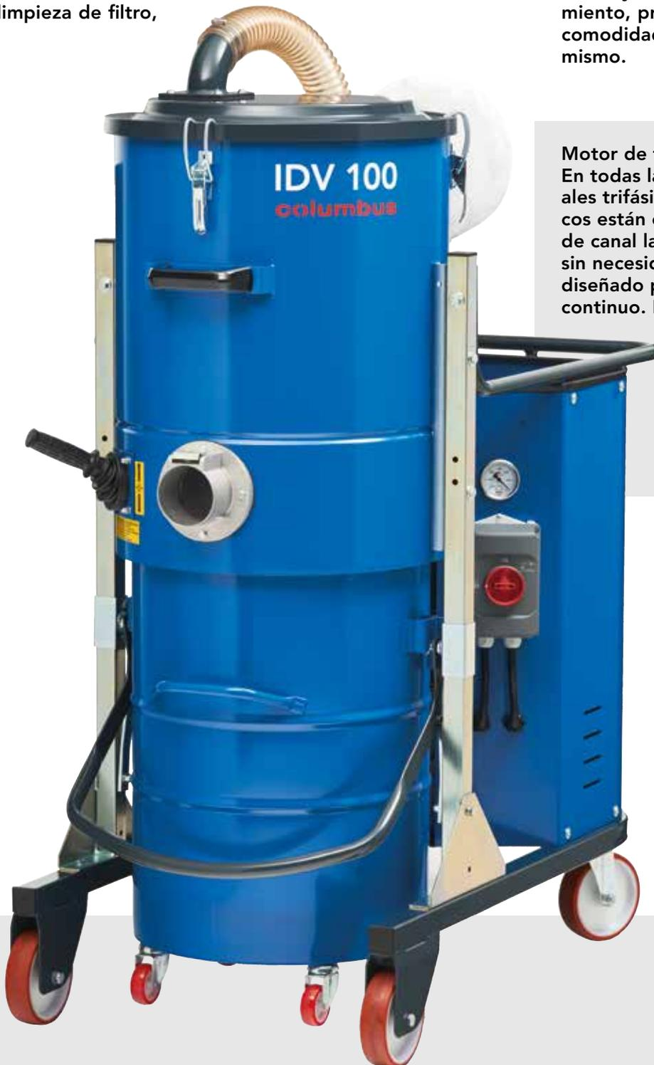
**Motor de turbinas de canal lateral:** En todas las aspiradoras industriales trifásicas, los motores trifásicos están equipados con turbinas de canal lateral. Son duraderas, sin necesidad de mantenimiento y diseñado para un funcionamiento continuo. La compresión doble del flujo de aire, en las turbinas de canal lateral, puede ser comparada con un motor de un enorme ventilador, produciendo una gran columna de aspiración.
